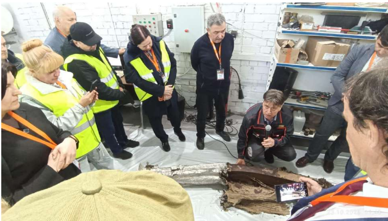
Фото 9 Разбор последствий огневых испытаний колонны под нагрузкой.
