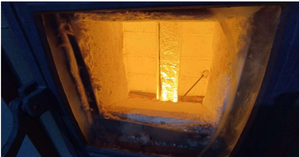
Фото 6 Огневое воздействие на колонну.
