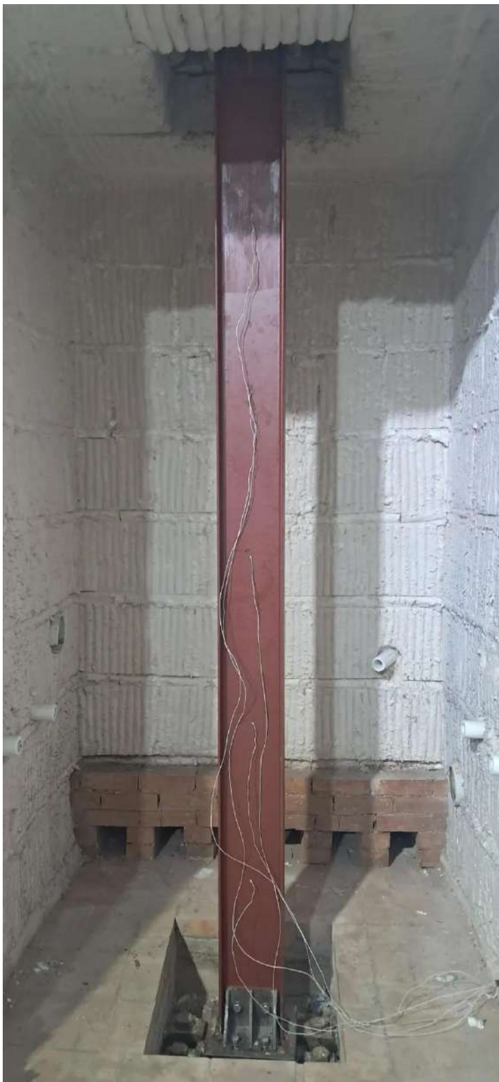
Фото 1 Колонна установленная в печь перед монтажом огнезащитной системы
