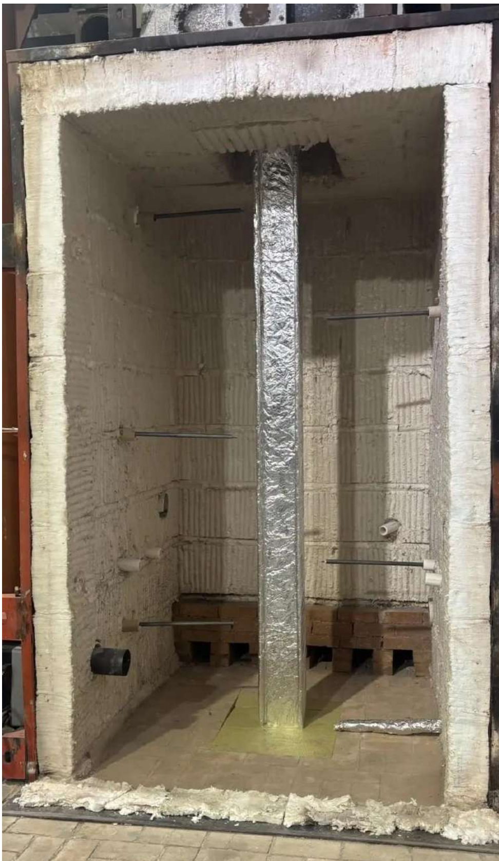
Фото 2 Колонна установленная в печь перед началом огневых испытаний
